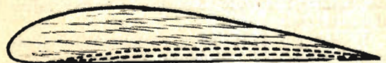
Fig. 6 Il profilo delle centine di attacco e quello delle centine di estremità varia con una variazione graduale, non brusca.
